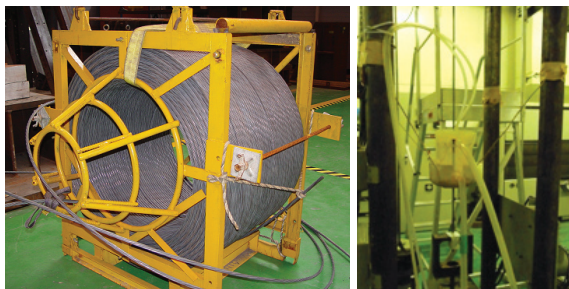
사진 1. 고강도 강연선과 응력부식 시험
