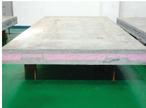
사진 1. 중단열 벽체의 형상 및 단면 예
