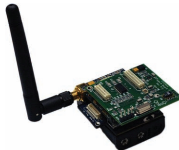
사진 2. ISM400 센서보드를 탑재한 Imote2 스마트 센서 플랫폼
