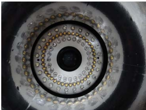
그림 2. 설진기 LED 광원 배치 Fig. 2. Placement of the LED Light Source in the developed Device
