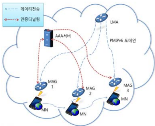
그림 1. PMIPv6의 네트워크 구조 Fig. 1. PMIPv6 network architecture
