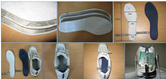
그림 2. 제작된 센서 및 측정회로 장착 모습 Fig. 2. Fabricated Sensor and Measurement Circuit
