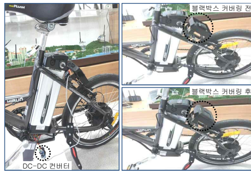
그림 7. 블랙박스과 DC-DC 컨버터 모습 Fig 7. Photos of the Black Box and DC-DC Converter
