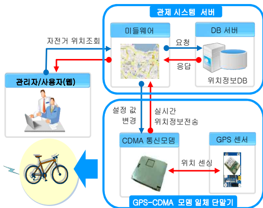
그림 1. LBS 기반 자전거 관제 시스템 구조 Fig. 1. Architecture of the LBS-based Bicycle Monitoring System
