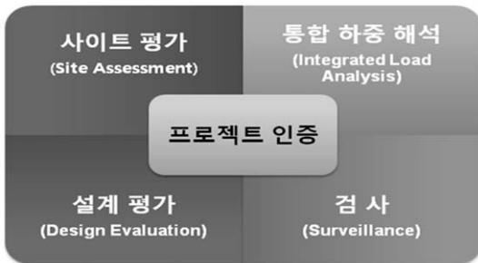
전기 및 특정 기초 설계가 해당 사이트의 외부조건을 충족시키는지 여부와 적용 가능한 지역 법규 및 해당 사이트에 관련되는 기타 요구사항과 일치하는지를 확인하는 것이다. 이 인증은 그 사이트에서의 바람 조건, 기타 환경조건 및 전력계통 조건 및 토양특성이 그 풍력발전기 형식 및 기초에 대해 설계문서에 정의된 내용을 충족시키는지를 확인하는 것이다. 또한, 설치 및 시운전이 지정된 규격 및 기타 기술 요구사항에 따르는지를 확인하며, 풍력발전기가 관련 매뉴얼에 따라 운전 및 정비되고 있는지를 확인하여야 한다. 프로젝트 인증의 절차는 사이트의 바람조건, 전력
