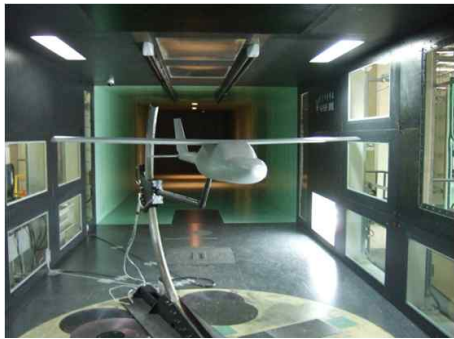
Fig. 3. 측정부에 설치된 기본형상
