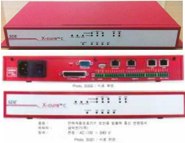
사진 2. 전력계통기기 보안용 출력력 변환장치 X-Cure-C Photo 2. X-Cure-C, In-out switch machine for security of the Power System
