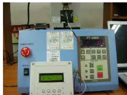
그림 10. 인장 시험기를 이용한 추력시험
