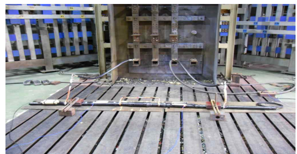
그림 7. 직선접속부 단락시험 구성 Fig. 7. Set-up of the short-circuit test for splice
