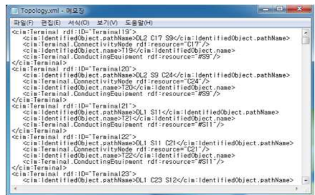
그림 10. CIM 기반의 토폴로지 데이터 Fig. 10. CIM based topology data
