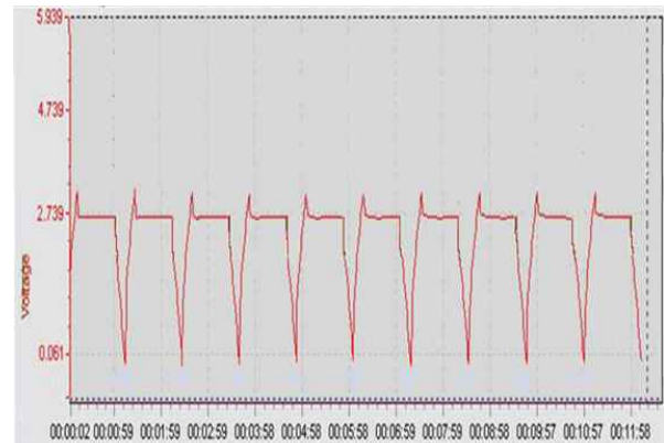
(b) EDLC 전압 실험 결과 (b) Voltage test result for EDLC
