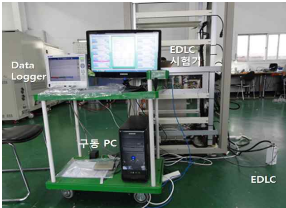
그림 10. EDLC 충방전 시스템 실험 Fig. 10. Charge/Discharge systems for EDLC
