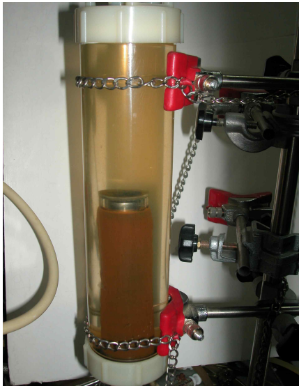
Fig.5. 공기유입조건에서 철슬러지의 자력분리조 내에서의 부착상태
