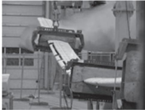
그림 5 블레이드 실규모시험 및 음향방출 기법을 통한 결함 평가
