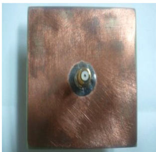
그림 4. 25x25mm 4T 안테나 구현 Fig. 4. 25x25mm 4T antenna implementation
