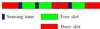
그림 2. 기 사용자 채널 접속을 위한 시간 프레임 구조. Fig. 2. Time frame structure for channel access to the primary user channel.
