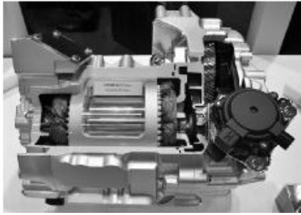
그림 12. Nissan 'LEAF' 탑재 영구자석모터의 단면도 모델 Shin-Etsu Chemical의 Dy저감 NdFeB영구자석 탑재 [20]
