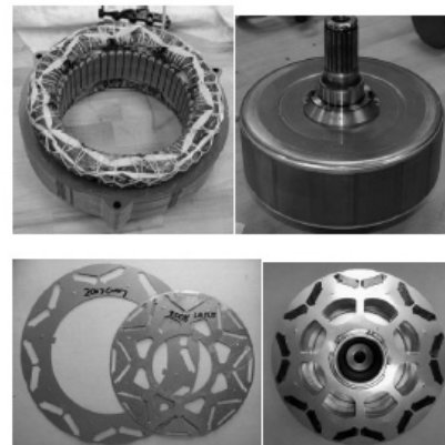
그림 11. 2010형 Prius의 회전자와 고정자 및 Camrey 하이브리드와 Lexus 600h 하이브리드자동차용 모터 회전자용 적층전자강판 [19]
