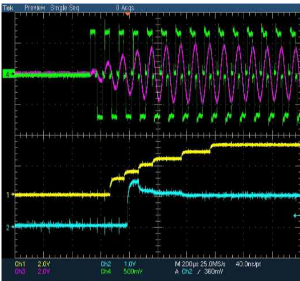
그림 15. 제안된 알고리즘을 이용한 반응기 파라미터 추출 I Fig. 15. Reactor parameter extraction according to the proposed algorithm (Ch1: 위상차(20/div), Ch2: 반응기 파라메타(1[uF.div]), Ch3: 인버터 전류(100[A/div]), Ch4: 인버터 전압:250[V/div])
