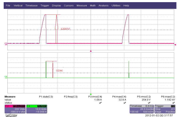
그림 14. 제논램프 실험 파형(10[Hz]/1,200[V]) Fig. 14. Zenon lamp test wave(10[Hz]/1,200[V])
