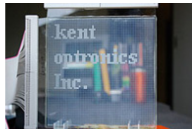
[그림 8] Kent사의 PSCT를 이용한 투명 디스플레이
