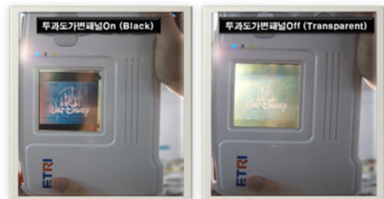
[그림 13] 투과도 가변 투명 AMOLED 패널에서 투과도 가변 패널의 On/Off에 따른 대조비의 변화
