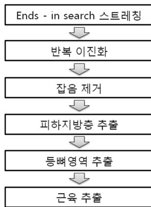
그림 1. 요부 영상의 근육 추출 과정 Fig. 1. Process of muscle extraction from lumbar image
