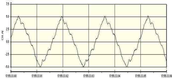
그림 5. 측정된 고조파 전류파형(A상) Fig. 5. Measured harmonic current waveform (Phase A)
