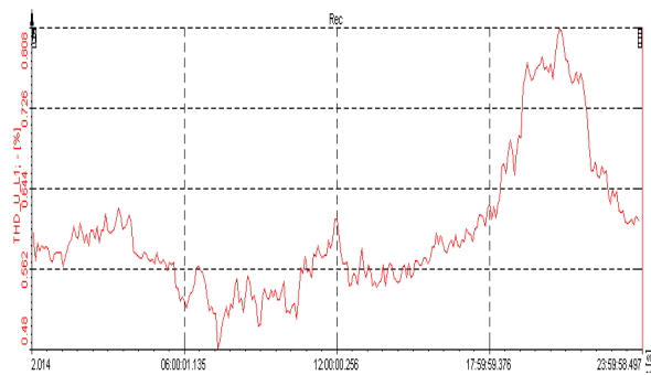
그림 8. 측정된 전압 THD 파형(A상) Fig. 8. Measured harmonic voltage waveform (Phase A)
