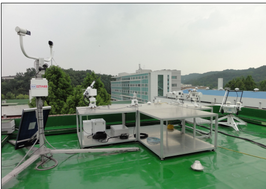
그림 1. 성분 및 파장별 일사량 자동측정시스템 설치전경
