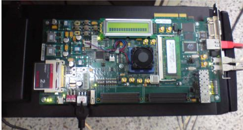
그림 8 ML605 기반 구현 시스템
