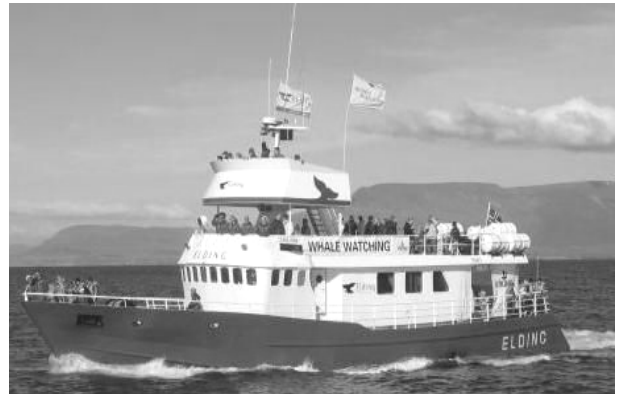
그림 6. 연료전지를 이용한 하이브리드 추진시스템 선박 - 고래탐사선
