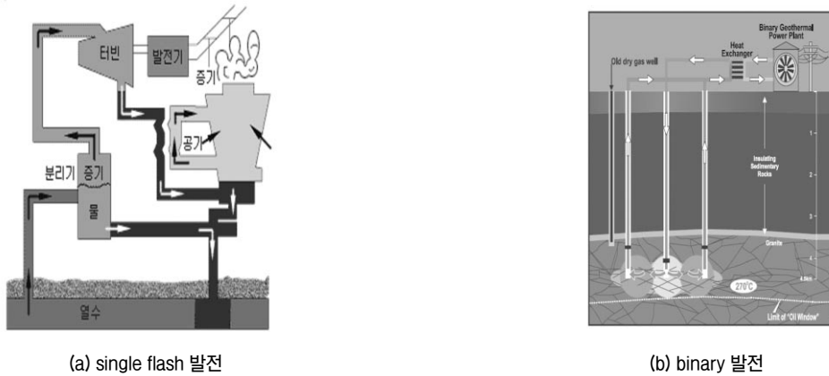
[그림 1] 지열발전플랜트의 구성 개념
