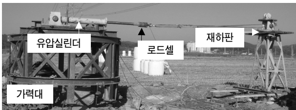
(a) 수평시험 전경
