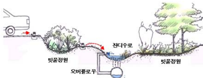
그림 11. 잔디수로 + 빗물정원 복합체계 개념도.
