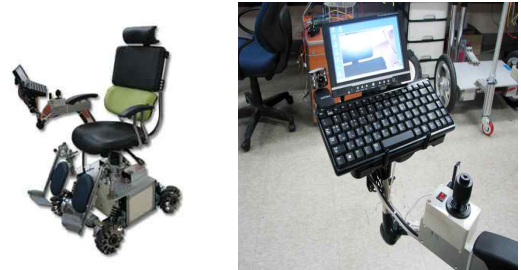
그림 1. NT-메카넴 지능형 휠체어 (4개의 메카넴바퀴로 구성된 휠체어)
