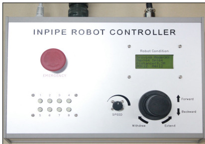
[그림 4] 배관 로봇을 위한 컨트롤 박스 [Fig. 4] Control box for in-pipe robot
