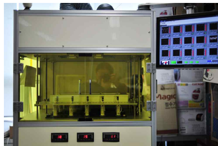
<그림 5> 슬림 커패시터(Slim capacitor) 고온가속시험장비
