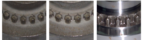
(c) cold forged (d) cold sized (e) machined
