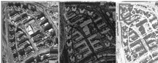
그림 6. 은평구 뉴타운 항공 LiDAR 데이터를 이용한 지면분류 및 초기입력자료 생성
