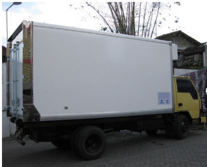
(b) 2.5 ton급 차량형 저온 컨테이너 제작 모습
