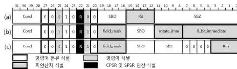
그림 4. 상태 레지스터 접근 명령어의 형식
