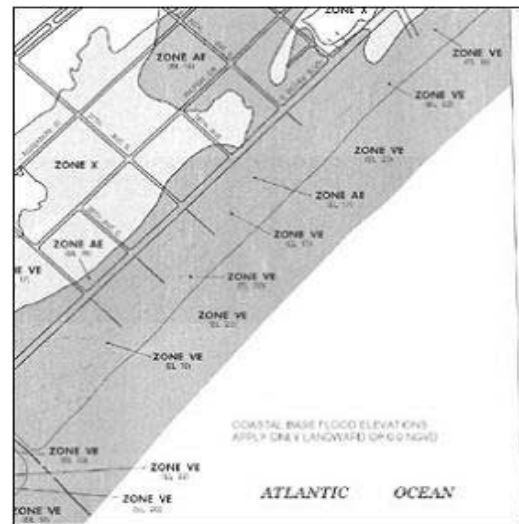
그림 2. 해안지역의 홍수지도 예 (Zone VE의 경우 100년빈도 홍수가 발생할 시 범람가능한 수위를 표시)
