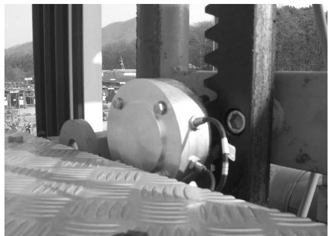
그림 9. 설치된 Double Sensor Type 정지위치감지장치
