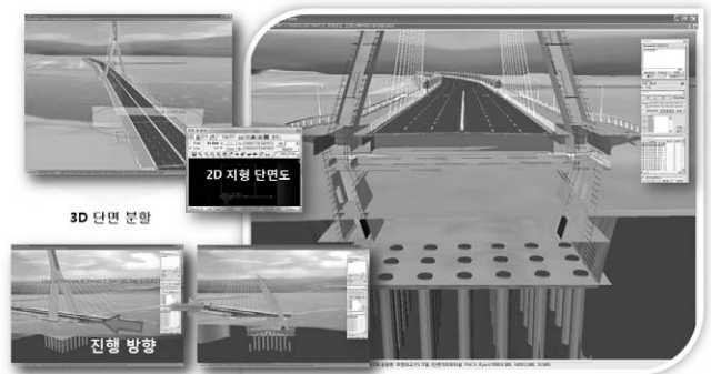
그림 14. 3D 단면 분할 및 2D 도면 생성
