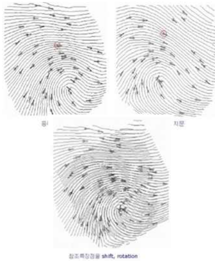
그림 10. 지문의 정합 과정 Figure 10. Matching process of fingerprint
