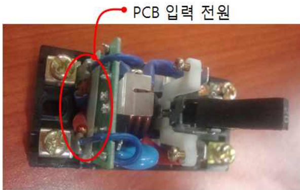
그림 4. 누전 차단기의 실제 내부 Fig 4. Inner part figure of ELCB
