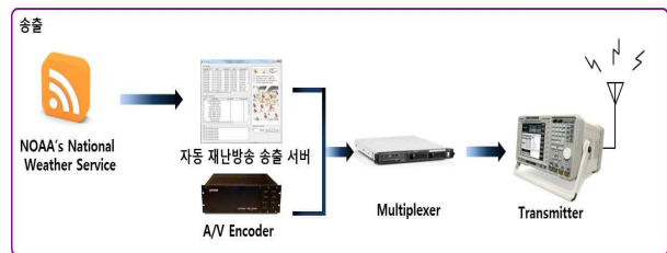
그림 4. 재난방송 송출 시스템 구성도 Fig. 4. Emergency service transmit system for ATSC Mobile DTV
