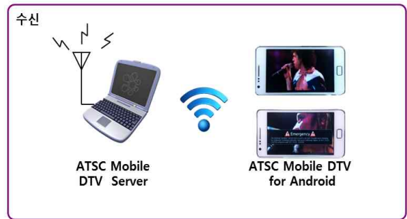
그림 8. 스마트폰 기반 재난방송 수신 환경 구성도 Fig. 8. EAM receive system for ATSC Mobile DTV
