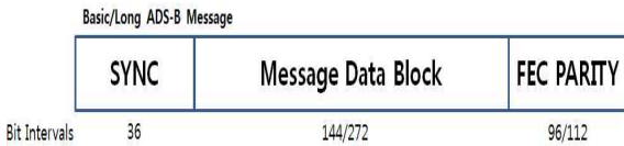
그림 7. UAT ADS-B 메시지 구성 Fig. 7. UAT ADS-B Message Components.
