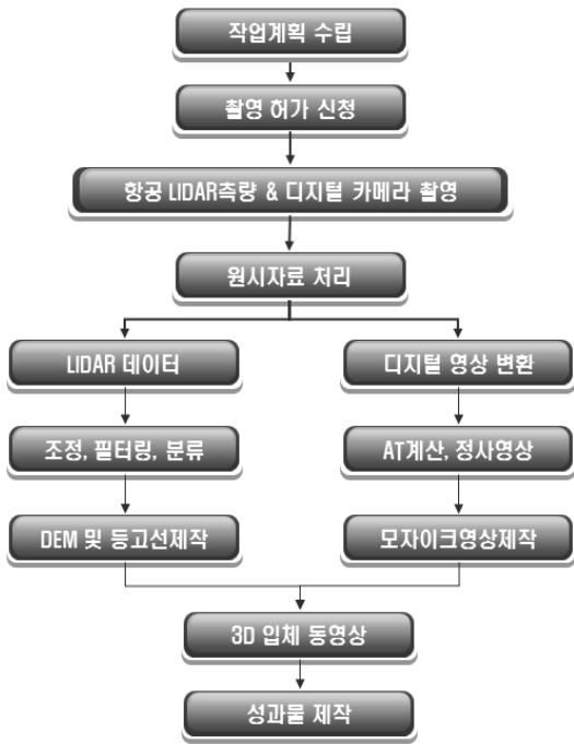
그림 2. 항공 LIDAR 처리 흐름도
