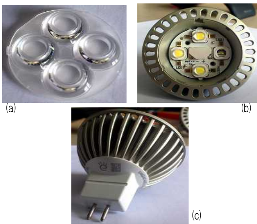
그림 1. 멀티 칩 LED 패키지의 구성 (a) 에폭시 몰드 (b) MPCB와 LED 칩 (c) 히트싱크
