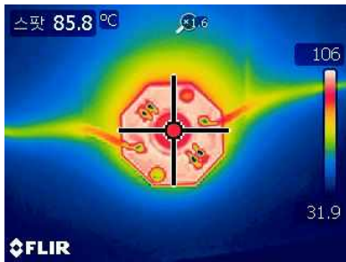
그림 6. LED패키지 몰드표면부위에 대한 IR 열화상카메라 측정 Fig. 6. IR camera image for the mold surface of LED package
