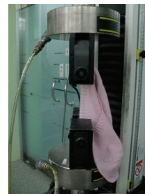
<그림 5> 시료의 넥크단 마무리 부분 인장강신도 실험
