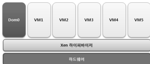
[그림 1] 게스트 도메인 부분의 VM 수가 5개인 Xen 시스템 기본 구조 예 ([7] 참고)
