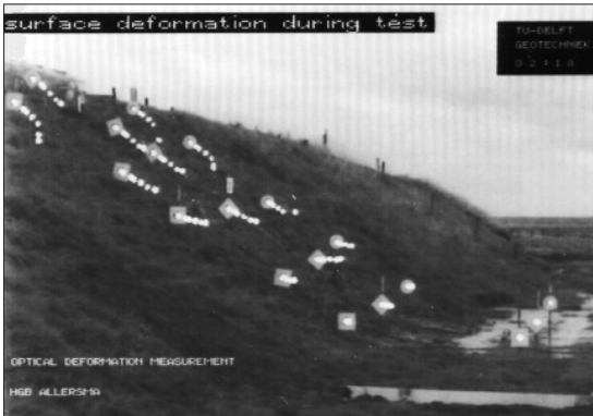
그림 4. 첫 번째 이미지에서 측정된 표지판 좌표점들 구역의 총 변위량을 시각화
