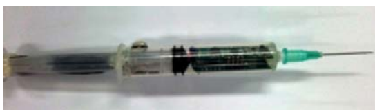
그림 2. 본 연구에서 개발한 정맥주사 시뮬레이터
