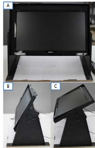
그림 7. WorkBench (A): 정면 모습 (B) 측면 80도 각도인 경우 (C) 측면 50도 각도인 경우
